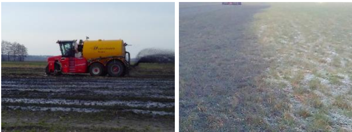
Afbeelding 1 – Links: Verspreiden van Waddenslib met een giertank met ketsplaat. Rechts: Het resultaat van het verspreiden met de ketsplaat.
